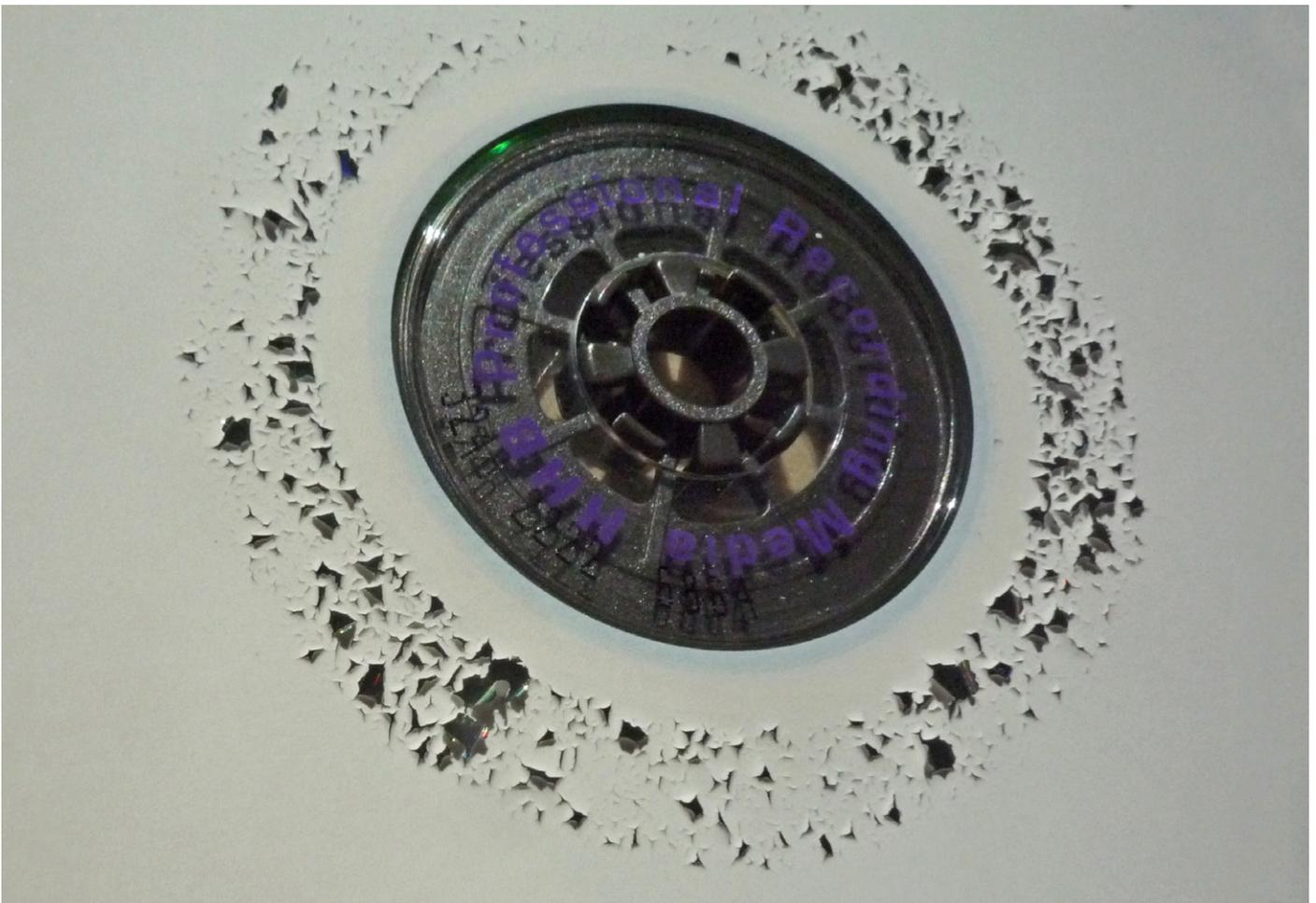
Die Qualität von CD-R-Rohlingen differiert selbst beim gleichen Hersteller je nach Produktionscharge erheblich. Im Bild ein mangelhafter CD-R-Rohling, der sich bereits nach vier Jahren in seine Bestandteile auflöste. Foto: Ruedi Müller
