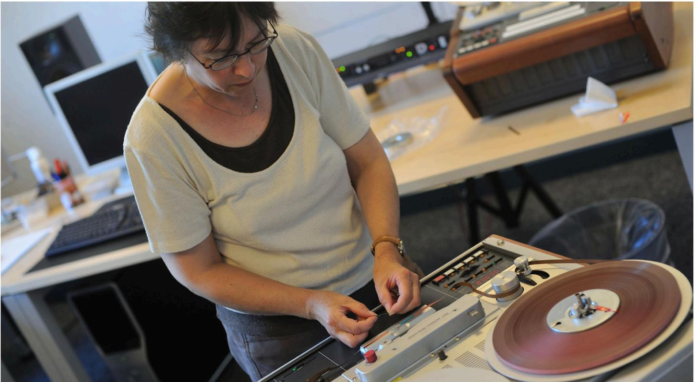
Eine Mitarbeiterin von SRF bereitet ein ¼-Zoll-Band zum Digitalisieren vor. Das Digitalisieren von Tonbändern erfordert vorbereitende und abschliessende Arbeiten wie Umspulen, Kontrollen auf Vollständigkeit, Reissen, Anbringen von Vorspann- und Abspannband (Allongen) und weitere Arbeiten der Archivpflege. Foto: Rudolf Müller
